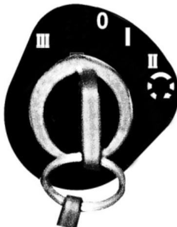
Рисунок 2.2.2 – Схема положений ключа выключателя стартера и приборов
