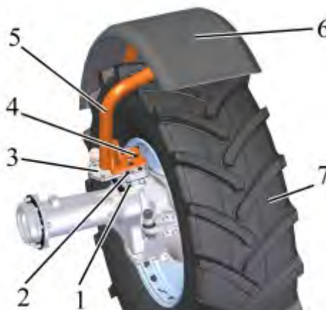
1 – втулка; 2 – болт; 3 – основание; 4 – болт; 5 – стойка крыла; 6 – крыло; 7 – переднее колесо. Рисунок 5.4.30 – Схема демонтажа и монтажа крыльев передних колес
