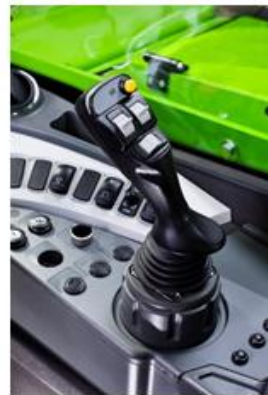
Электронный джойстик пропорционального типа с емкостным датчиком .
