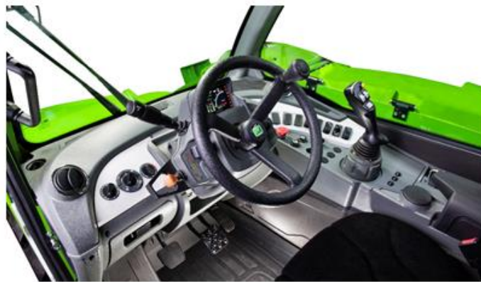
Электронный джойстик пропорционального типа с емкостным датчиком .
