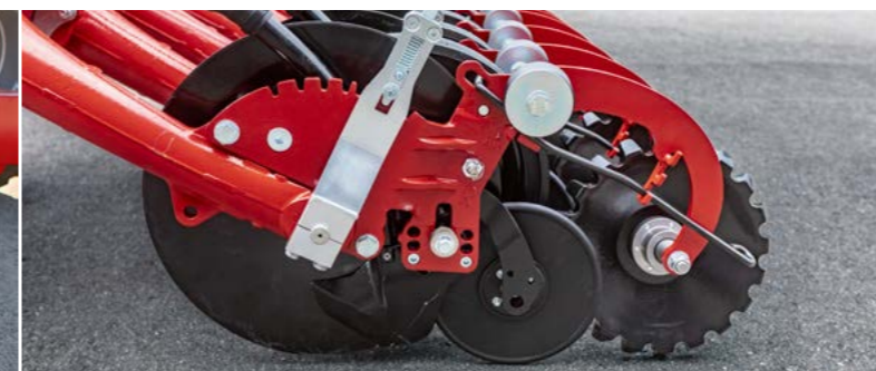
Стальной зубчатый прикатывающий ролик – создает мелкокомковатую структуру почвы и закрывает борозду
